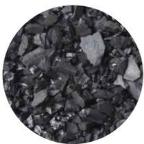
Nur 4 Gramm Aktivkohle haben eine Oberfläche, die einem Fußballfeld (6400 m<sup>2</sup>) entspricht. Es ist die extrem große Oberfläche, die es Aktivkohlefiltern ermöglicht, Verunreinigungen und andere Substanzen sehr effektiv zu absorbieren, also zu entfernen. Wir haben in den Kartuschen 170 g Aktivkohle-Granulat. Das ist mehr als 270.000 m<sup>2</sup> Oberfläche. Also ist auch hier für die beste Filterung gesorgt.
